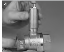
4 Našroubujte prodloužení dřívku. Páčkou lehce dotáhněte dřív tak, aby páčka zapadla do výřezu v prodloužení.
