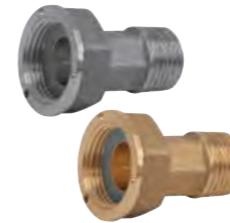
Šroubení k vodoměru, ploché těsnění. Rozsah teplot: 5÷110 °C Maximální provozní tlak: 10 bar
